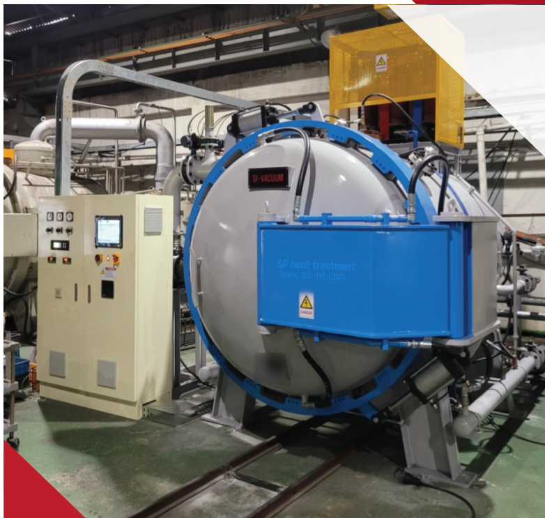
로템큐 프로세스 & 닉스 프로세스 전용 열처리로 (4호기 | 최대 냉각 압력 10bar)
